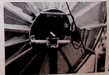
Afb. 4 Achterzijde van de parabool waarop de houtconstructie duidelijk zichtbaar is, evenals de beide versterkers V1 en V2 en het coaxiale filter.
